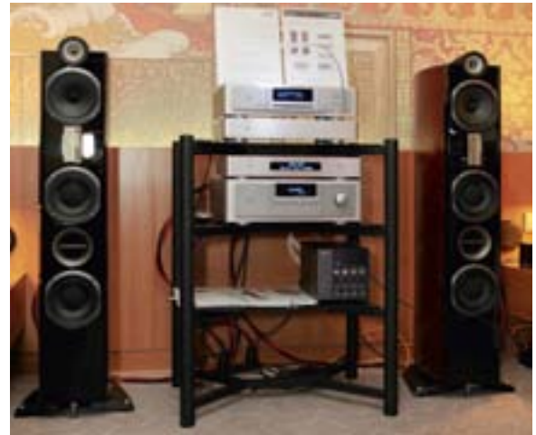
Компоненты NAD серии Master и акустические системы Triangle Delta из серии Signature. Все модели этой линейки имеют корпуса из семислойной ДВП, покрытые десятью слоями лака и твитер ZZ400, помещённый в отдельную акустическую камеру. Обратите внимание на патентованный фазоинвертор Twin Vent, порт которого разделён перегородкой на две части (TRIA International, Ltd.)
