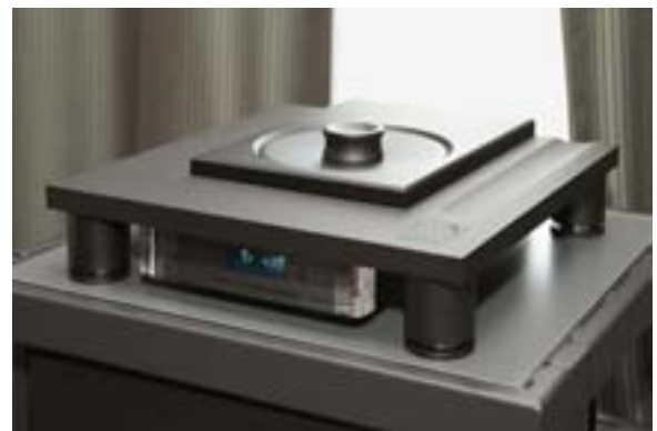
CD-транспорт Ypsilon CDT-100 — классический пример бескомпромиссного цифрового источника. Механизм с верхней загрузкой установлен на плавающей подвеске, которая, в свою очередь, крепится на массивном шасси. Сложная конструкция построена из плит-сэндвичей, состоящих из листов стали и алюминия. За счёт этого в ней отсутствуют резонансы и вибрации, присущие традиционным коробчатым корпусам (High End Centre)
