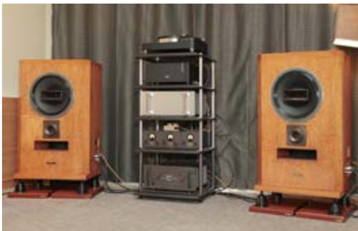
В трёхполосных рупорных системах Maxonic TW 1100 используется внешнее динамическое подмагничивание от источников постоянного тока EX-101. Регулируя ток электромагнита, можно подобрать оптимальный характер звучания для разных жанров и акустических условий. Чувствительность этих монстров 104 дБ, диапазон рабочих частот 25 Гц — 25 кГц, масса одной колонки 110 кг (High End Centre)
