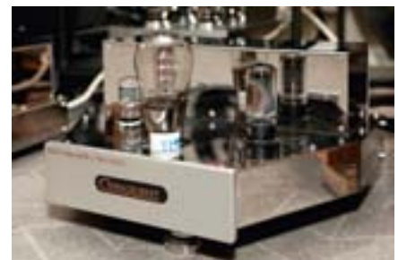
Компания Coincident Speaker Technology, несмотря на название, выпускает и ламповые усилители. Одна из последних разработок — моноблоки M300B Frankenstein MK II, построенные по всем правилам High End Audio. Навесной монтаж, разводка медью 6N, полипропилен в фильтре питания, кенотронный выпрямитель. На выходе — прямонакальные триоды 300B (Milky Sound)
